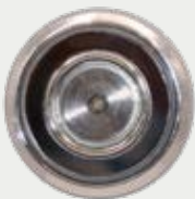
I-BUTTON Chiave elettronica antivandalo. Ip51
