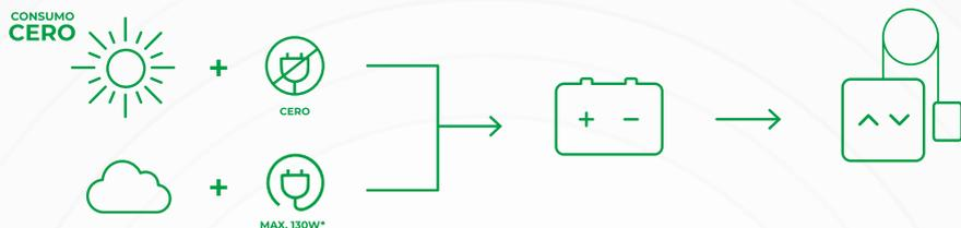
**ECO HYBRID** se utiliza en condiciones de mucho tráfico o cuando es necesario cargar las baterías rápidamente. En este modo el sistema puede utilizar el valor máximo de potencia contratada en la red (valor fijado en el momento de la instalación). \*
