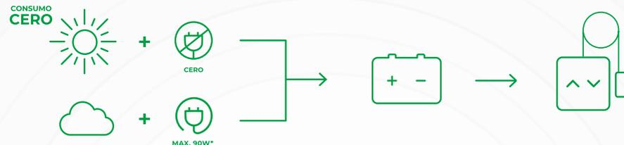
**ECO FULL** se utiliza en condiciones de tráfico bajo o moderado. En este modo, la potencia máxima\* absorbida de la red no supera el valor de potencia mínima necesaria para garantizar la carga de las baterías en caso de uso bajo o moderado de la plataforma.
